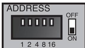
При помощи DIP переключателя на задней панели в двоичном коде следует установить номер блока резервирования в системе в соответствии с таблицей.
