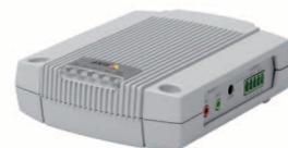
AXIS P8221 оснащен восемью цифровыми портами для ввода/вывода, которые могут быть запрограммированы на ввод или вывод. Порты для ввода могут быть подключены к датчикам, например, дверными замками, детекторами дыма или инфракрасным датчикам. Порты вывода можно использовать для подключения устройств управления или реле, например для удаленного управления открытием/закрытием дверей или включением/выключением света.
