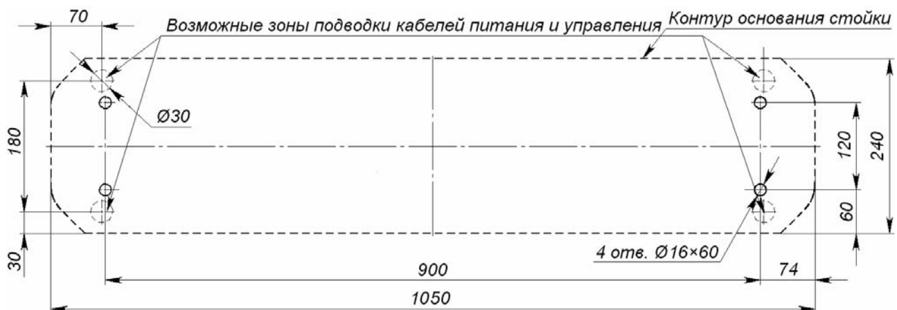
Рисунок 8 Схема разметки для установки стойки ЭП
