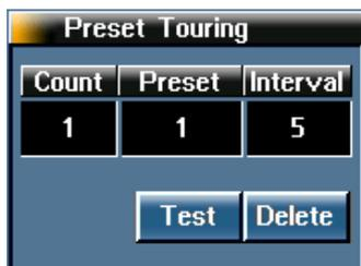
· В Патрулировании доступны следующие настройки Count No. 1 ~ 8 (Предустановки патрулирования) и 8 Presets (Предустановки камер) для сохранения предустановок патрулирования. Если в поле Preset установить значение 1~8 и нажать кнопку “Test”, камеру будет переходить от одной предустановки к другой (от 1 до 8).
