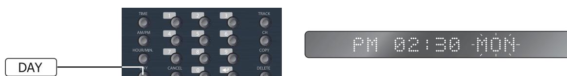
6) Нажмите кнопку ENTER для сохранения настроек. Установленное время отображается на дисплее. При нажатии кнопки CANCEL устройство переходит в ждущий режим без сохранения настроек.
