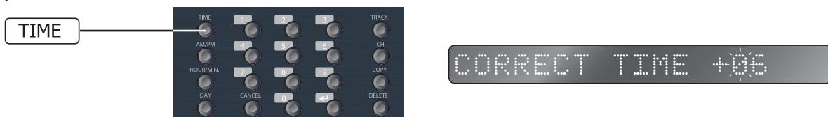
2) Установите корректирующее значение в секундах с помощью кнопок 0—9. Текущее время корректируется в пределах от -30 до +30 секунд. По умолчанию на дисплее отображается '+06'.
