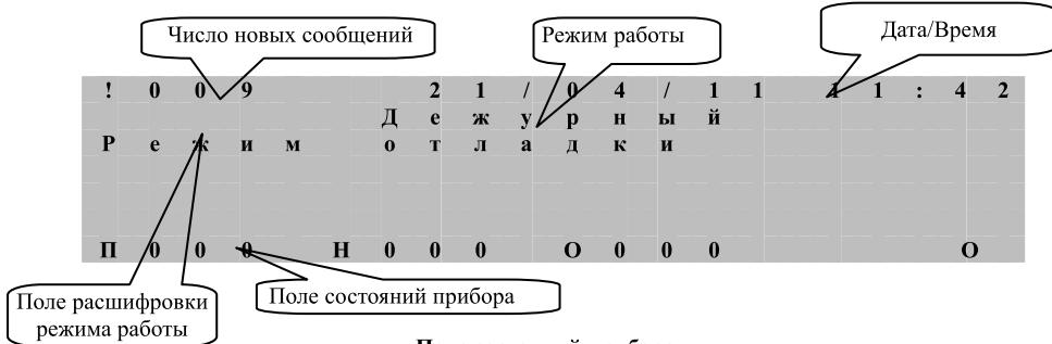
В данном поле отображается количество зафиксированных случаев пожара (П), неисправностей (Н) и тревог (Т). В случае ненулевого значения счетчика, он начинает моргать.
