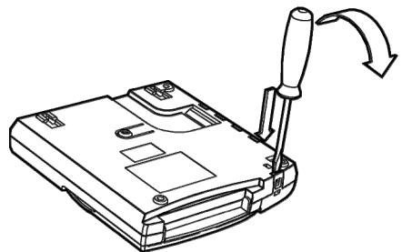
Установка пульта выполняется по-разному в зависимости от необходимости использования датчика отрыва от стены. Датчик отрыва от стены предназначен для контроля несанкционированного открепления пульта от стены. При срабатывании датчика отрыва от стены на радиорасширитель – координатор радиосети (РР 0) передаётся извещение "Взлом".
