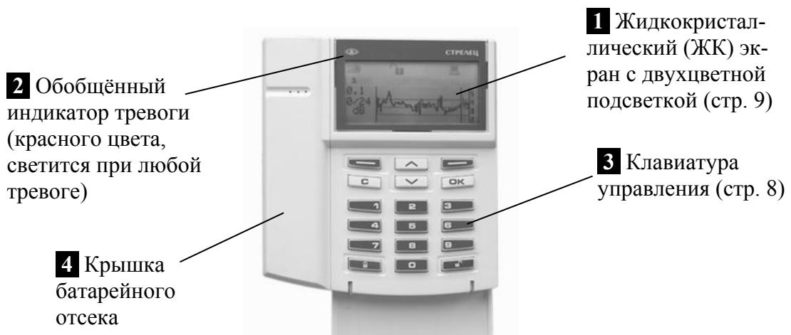
Для снятия крышки батарейного отсека необходимо использовать отвёртку.
