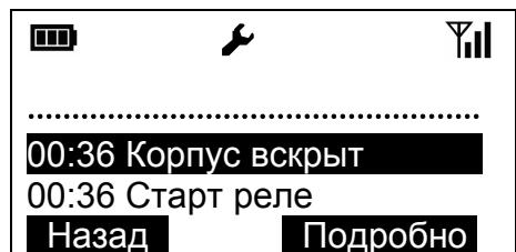
При нажатии экранной клавиши < Подробно > открывается окно с детальным описанием события, включающим дату, время и место события (номер расширителя, адрес и вид устройства). Номер раздела сопровождается текстовым описанием (дескриптором) раздела.
