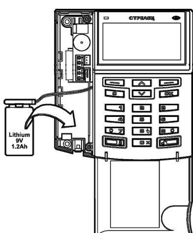
Батарея подключается к соединительной клеммной колодке и устанавливается в батарейный отсек.
