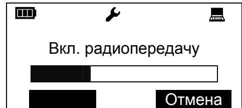
Активируйте радиопередачу (по обычной процедуре в радиосистеме "Стрелец", переведите переключатель "Прог." на устройстве в положение, обратное положению "ON").
