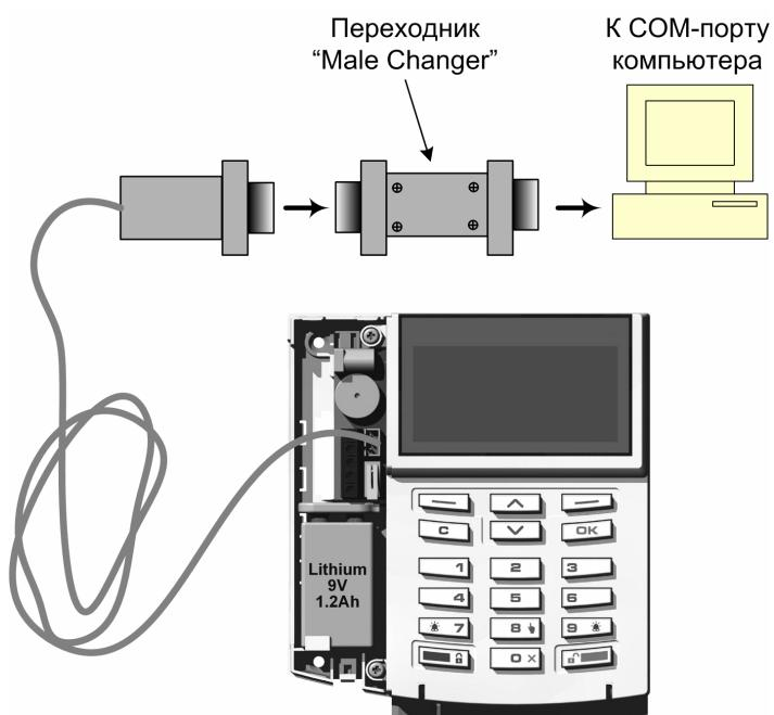
Для синхронизации конфигурации радиосистемы с компьютером<sup>1</sup> используется переходник "Male Changer", имеющийся в комплекте поставки.
