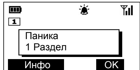
Выключение звуковой сигнализации возникших событий о неисправностях или тревогах произойдёт автоматически по истечении 2 мин либо при нажатии любой клавиши пульта.
