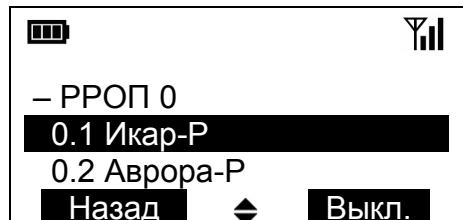
При успешном выполнении операции назначение экранной клавиши изменится на < Вкл. > и, по истечении периода передачи контрольных сигналов извещателя (по умолчанию – 32 с), возникнет окно с сообщением о включении обхода адреса.
