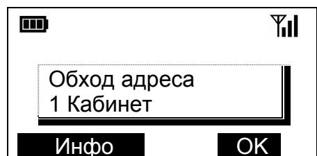
Извещатель, находящийся в обходе, считается радиосистемой неисправным, что индицируется пиктограммами в верхней части экрана.
