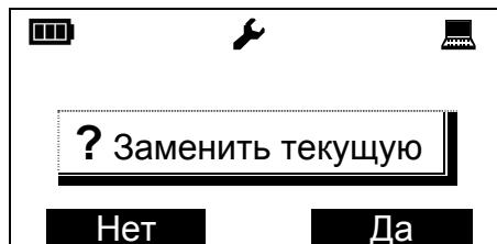
При утвердительном ответе пульт приступает к процедуре считывания свойств всех устройств радиосистемы. Считывание проводится автоматически последовательно из каждого радиорасширителя системы, начиная с координатора радиосети<sup>20</sup> (PP 0).
