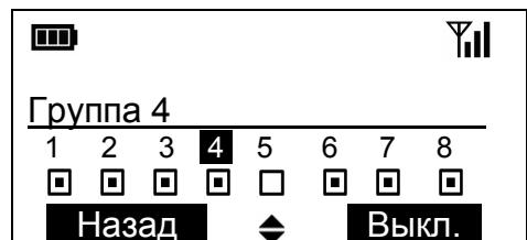
Включенные группы отмечены точками на экране. Для включения/выключения групп переместите указатель с помощью клавиш < ◇ > и нажмите экранную клавишу < **Вкл.** > / < **Выкл.** >.
