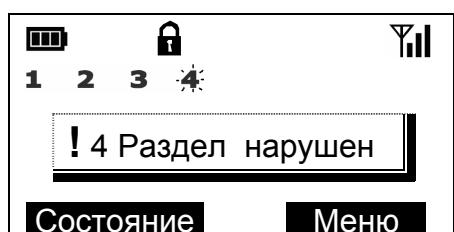
При наличии нарушенных извещателей и разрешённом форсированном обходе в опциях радиорасширителя на экране отобразится окно с запросом об обходе извещателя.
