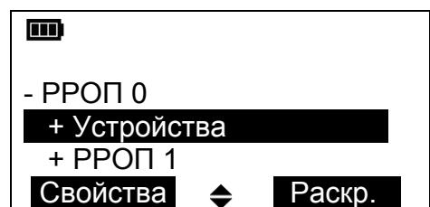
Для выполнения какого либо действия с выделенным элементом нажать на экранную клавишу **< Действ.**. Клавиша **< Действ.** станет активной для устройства, если в дереве топологии оно раскрыто (отмечено знаком "-").
