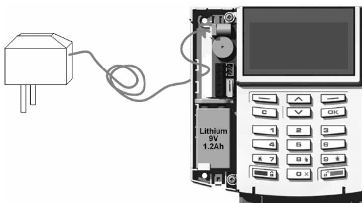
Провода внешнего источника питания подключаются к клеммам стационарного подключения.
