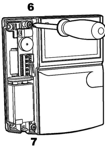
При подключении внешнего источника питания (блока питания DC 10,8-27 В или сетевого адаптера DC 12-27 В, AC 9-24 В) пропустите соединительные провода через отверстие в основании пульта.
