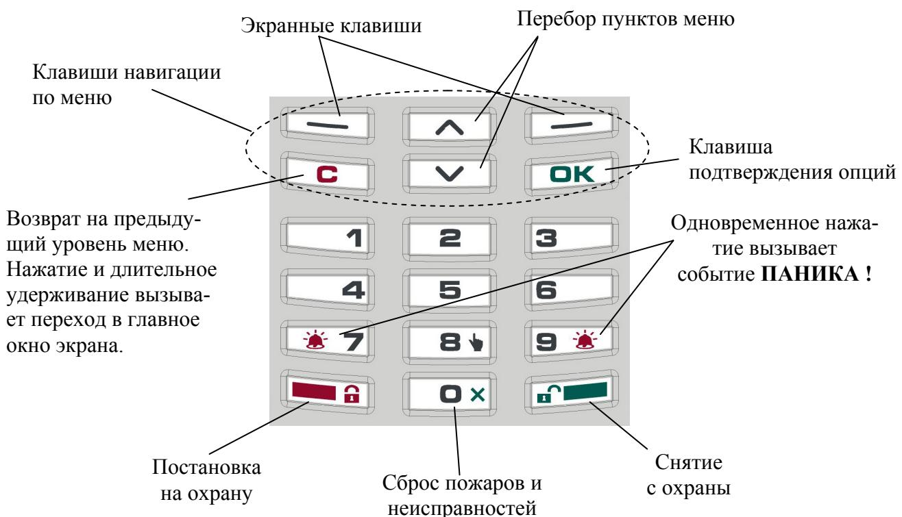
Специализированные клавиши  $\leftarrow\rightarrow$  (взять) и  $\square$  (снять) предназначены для постановки на охрану и снятия с охраны соответственно. С помощью клавиши  $\square \times$  выполняется сброс пожарных тревог и неисправностей.
