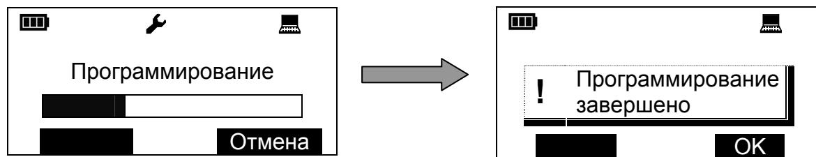
При необходимости повторного программирования радиорасширителя выделите его в дереве сетевой топологии, раскройте элемент, нажмите экранную клавишу < **Действ.** > и выберите действие "Запрограммировать".
