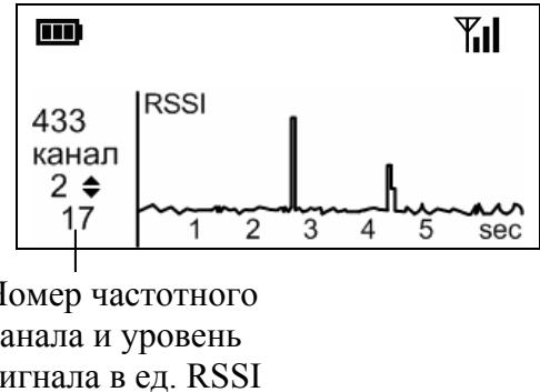
Номер частотного канала и уровень сигнала в ед. RSSI
