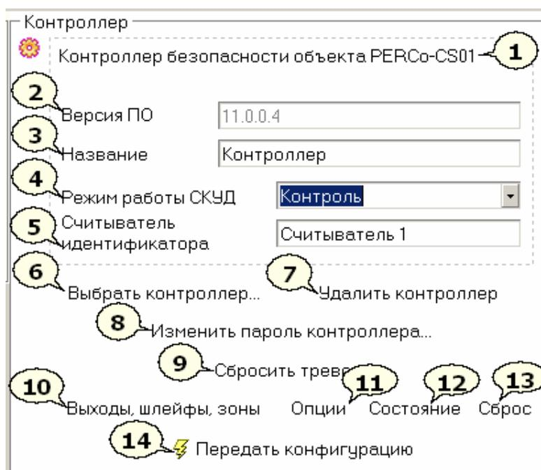
1. Строка описания контроллера – содержит название модели и тип подключенного контроллера.
