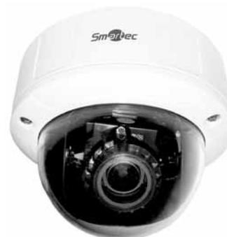
Встроенный обогреватель и уровень климатической защиты IP66 обеспечивают возможность уличной установки камеры. Диапазон рабочих температур составляет от -40° С до +50° С.
