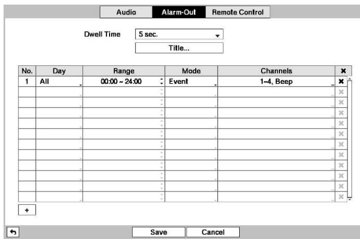
Рисунок 31. Настройка устройств – экран настройки тревожных выходов.
