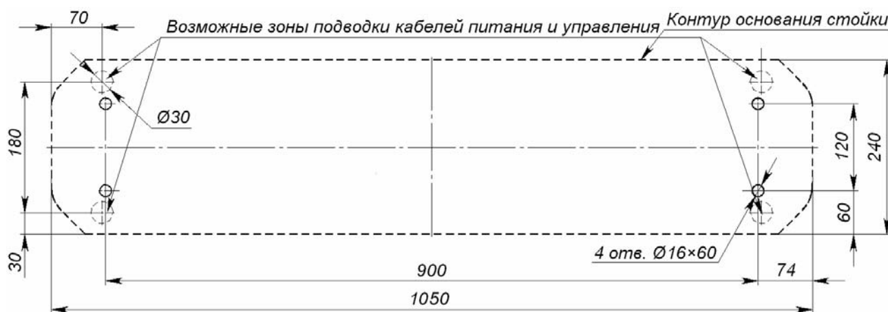
Рисунок 9 Схема разметки для установки стойки турникета
