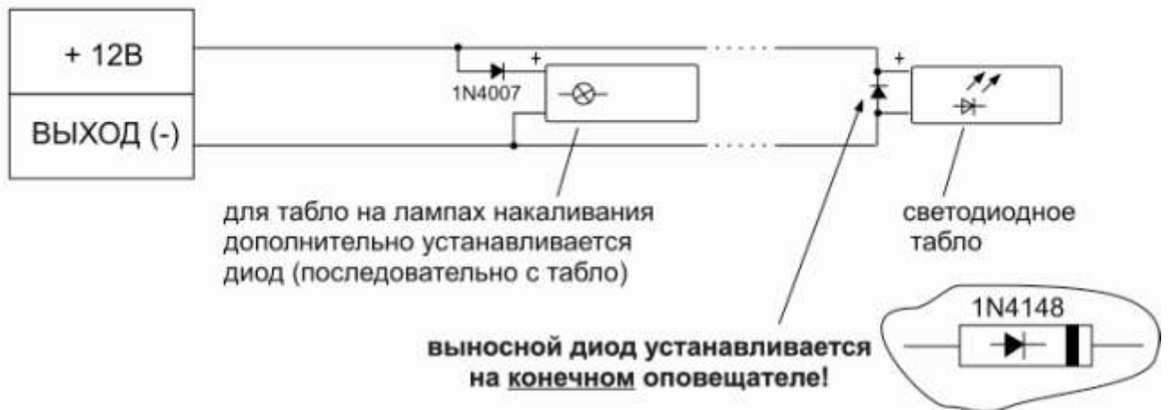
Рис. 20. Схема подключения нескольких световых табло
