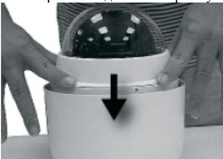
8. Используя один Винт М3 и два оригинальных винта, прикрутите купол к корпусу камеры.
