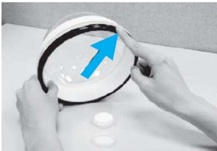
Отметьте, что небольшой выступ на куполе должен совпасть с одним из четырех отверстий в корпусе камеры
