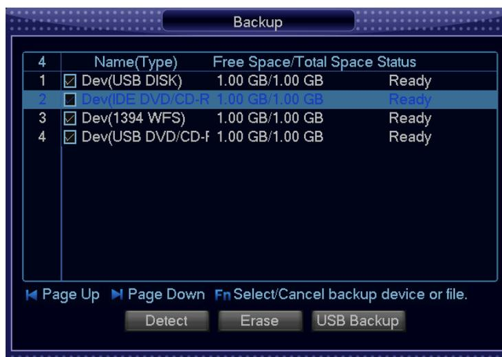
**Detect (Обнаружение):** обнаружение портативного USB-устройства, подключенного к цифровому видеорегиcтpатору, а также отображение имени устройства и информации об объеме свободного пространства / общем объеме.
