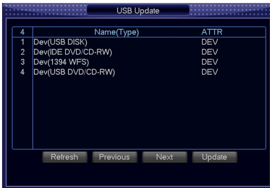
Подключите к порту USB на задней панели USB-уcтpойcтво, на котором записан файл обновления, и затем выберите этот файл. Обновление охватывает ядро, u-boot, установки, приложения и файловую систему.
