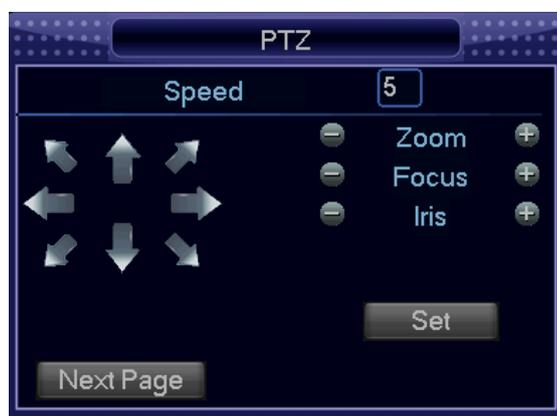
Speed (Скорость): обычно используется для управления в определенном направлении. Например, шаг 8 намного быстрее, чем шаг 1. (Введите значения в диапазоне от 1 до 8 с помощью мыши или передней панели. Максимальная скорость: 8).
