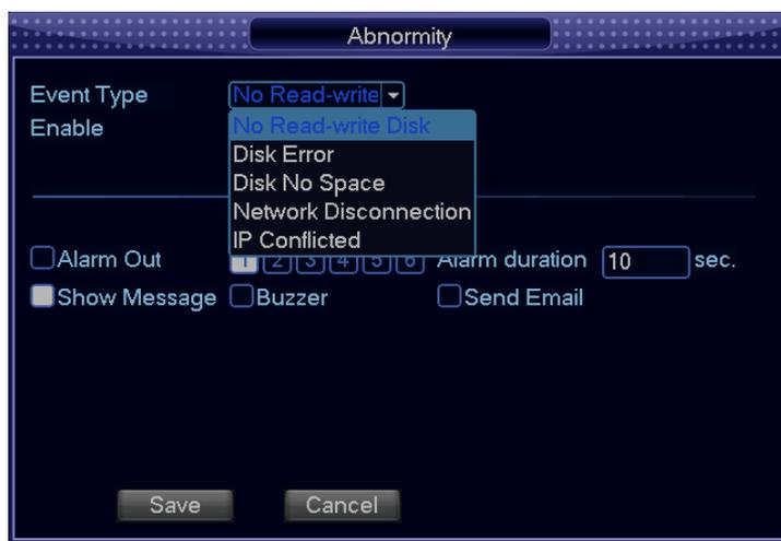
**No Read-write Disk (Отсутствует диск):** цифровой видеорегиcтpатор не может подключиться к диску или произошла аппаратная ошибка.
