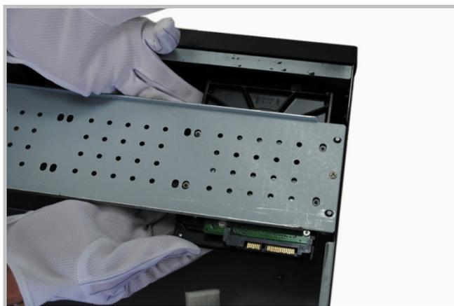
**4.** С помощью специально предусмотренных винтов закрепите жесткий диск на кронштейне.
