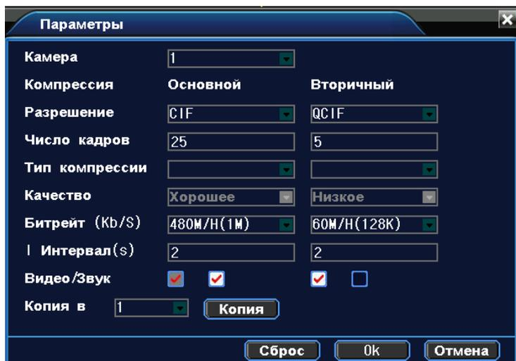
Рисунок 4.11 Установка кодирования
