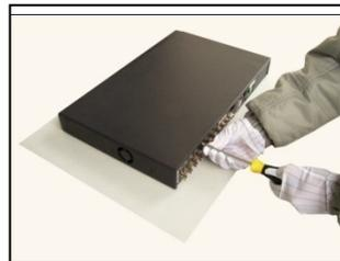
8. Зафиксируйте крышку винтами
