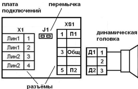
Рис.1 Структурная схема «АС-3-2»
