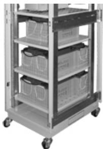
2. Разместить на нижних полках шкафа аккумуляторные батареи, входящие в комплект поставки, и выполнить, с соблюдением полярности, их последовательное соединение при помощи перемычек АКБ, (НЕ входят в комплект поставки), аккумуляторная батарея комплекса собирается из восьми последовательно соединенных аккумуляторных батарей (входят в комплект поставки), в соответствии со схемой, см. приложение. При монтаже, на
