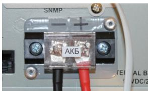
3. Подключить к ИБП провода, идущие от АКБ, собранной по п.1, соблюдая полярность (к клемме «+» подключить провод красного цвета, к клемме «-» - черного). Закрыть колодку прозрачной защитной крышкой.
