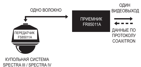
ОДНОКАНАЛЬНАЯ ПЕРЕДАЧА ВИДЕОСИГНАЛА И ПЕРЕДАЧА ДАННЫХ ПО ПРОТОКОЛУ COAXITRON
