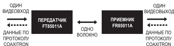
ОДНОКАНАЛЬНАЯ ПЕРЕДАЧА ЦИФРОВОГО ВИДЕОСИГНАЛА И ПЕРЕДАЧА ДАННЫХ ПО ПРОТОКОЛУ СОАХИТРОН
