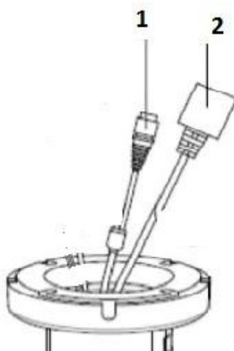
1. Питание 12 В пост. Служит для подключения сетевого кабеля к сети питания 12 В постоянного тока.
