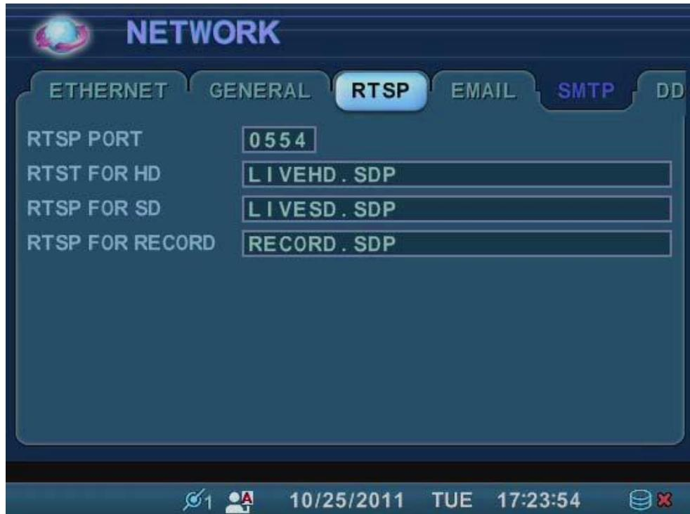
RTSP представляет собой управляющий протокол, описывающий, какой транспортный протокол использовать для передачи потокового видео. При работе в режиме реального времени очень важно своевременно передавать потоковые данные даже в случае пропадания отдельных изображений.
