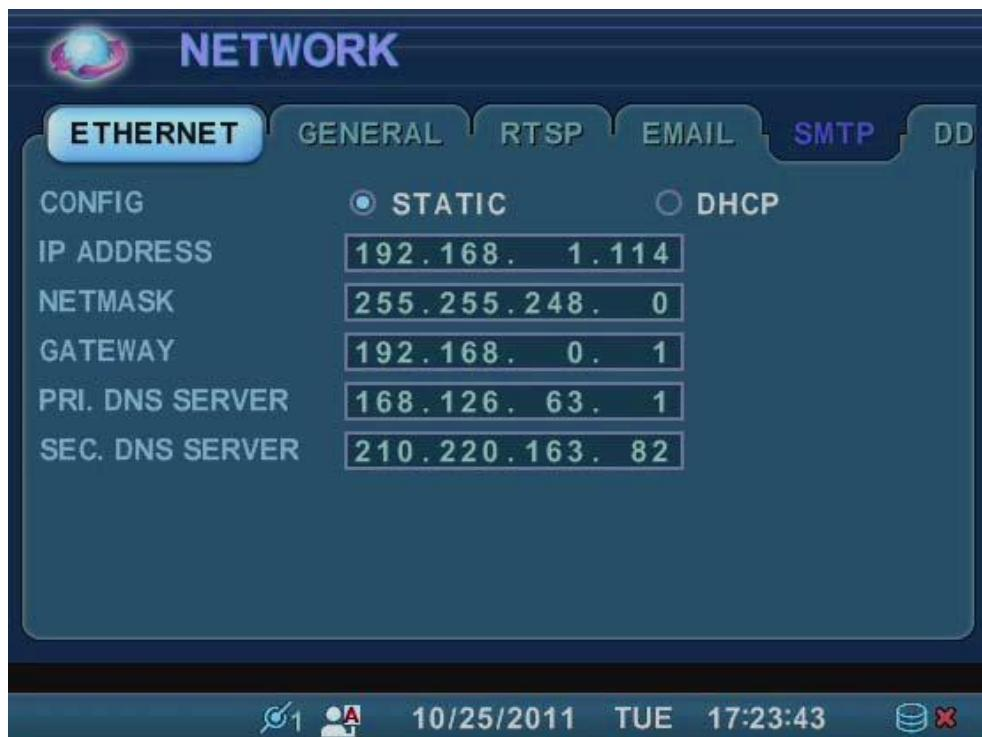
1) В строке **Config** (Конфигурация) предлагается на выбор две опции: Static (Поддержка статических адресов) или DHCP (Поддержка динамических адресов).
