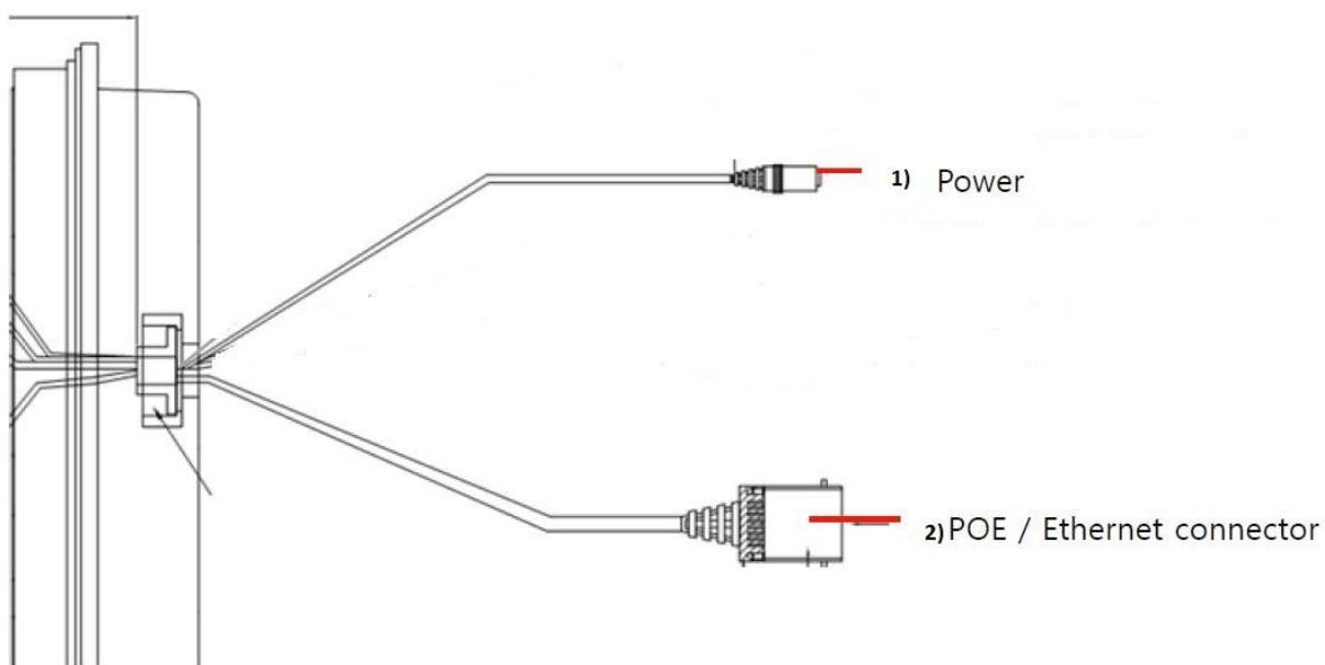
1. Питание 12 В пост. Служит для подключения сетевого кабеля к сети питания 12 В постоянного тока.
