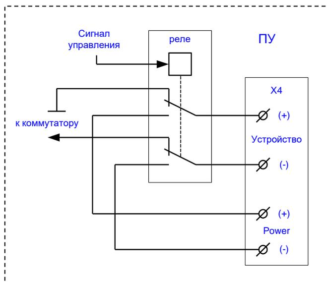
**Внимание!** Не допускается объединять выходы управления устройствами. Ограничение связано с возможным одновременным включением или выключением реле, что может привести к выходу из строя коммутатора.
