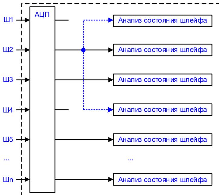
На рисунке приведен пример алгоритма копирования значений АЦП. Синими пунктирными линиями показаны каналы копирования значений АЦП. При этом собственные значения АЦП для таких шлейфов остаются неостребованными (Ш1, Ш4 на рисунке), а состояние таких шлейфов никак не контролируется. Результат работы алгоритма копирования получится следующим:  $АЦП_{Ш1} = АЦП_{Ш2} = АЦП_{Ш4}$ . Дальнейший анализ состояния шлейфов осуществляется как описано в п.5.3.1.
