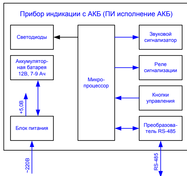
Рис 2. Функциональная схема ПИ исполнения АКБ
