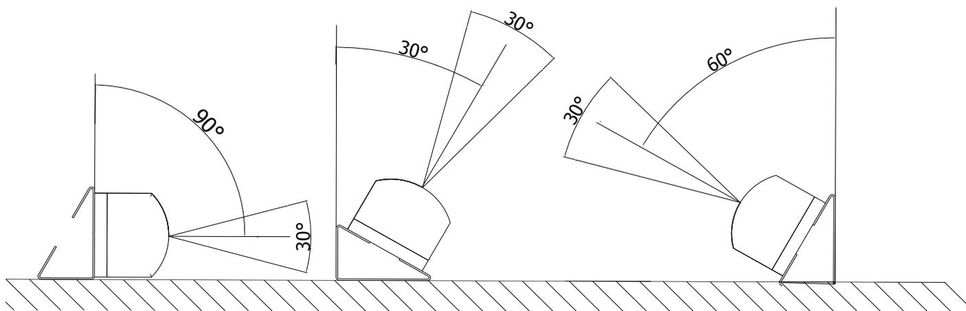
Рис. 2 Варианты установки извещателя на кронштейне
