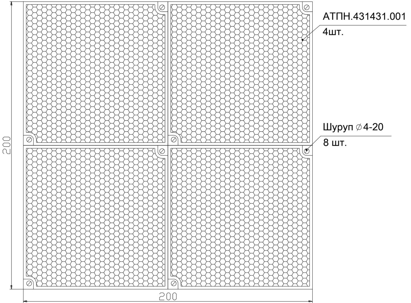
Рисунок 2 Монтажный чертеж четырех отражателей
