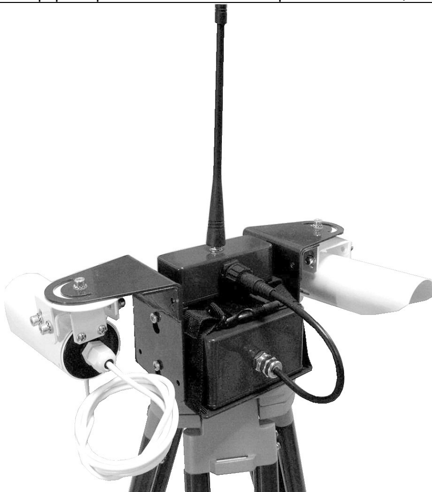
Фотография 9 Стойка СТР «Плющ» с установленными извещателями ИКС-1 исп.5
