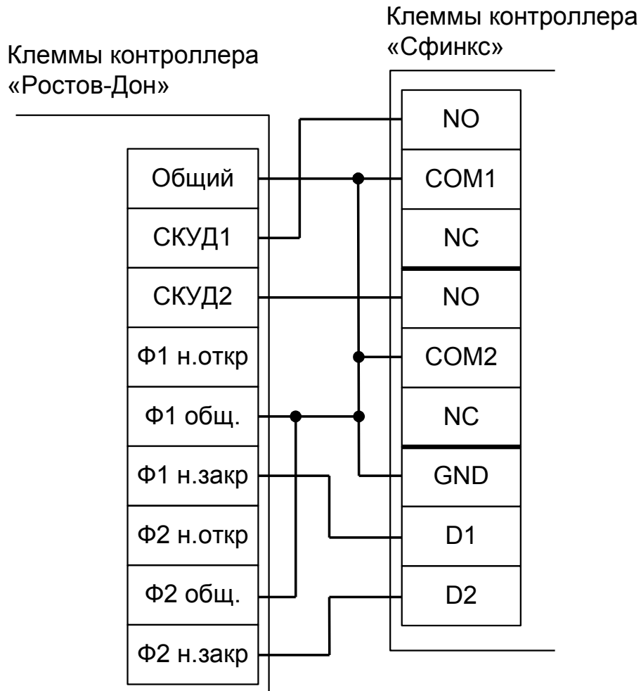
Рисунок 82. Турникеты и калитки «Ростов–Дон», новая электроника, вариант №1.
