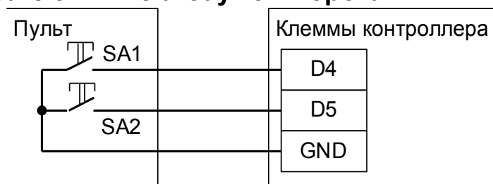
Рисунок 133. Пульт ручного управления шлагбаумом/воротами, вариант №1.
