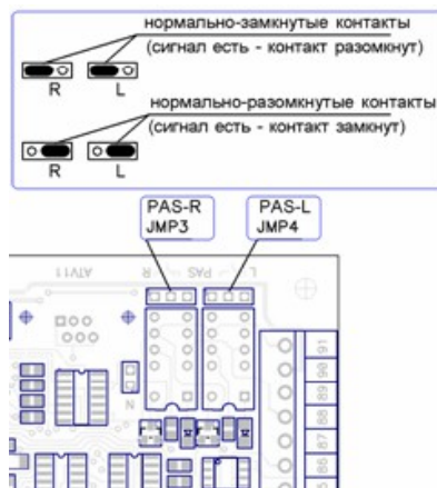
Рисунок 71. Перемычки JMP3 и JMP4 контроллера ОМА–DD.958, ОМА 264MC1, 866.MC2.
