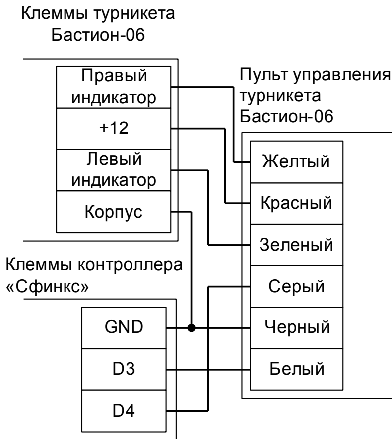
Рисунок 93. Первый вариант подключения пульта управления «Бастион-06» и «Бизон».
