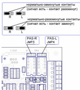
Рисунок 76. Перемычки JMP3 и JMP4 контроллера OMA 264MC1.
