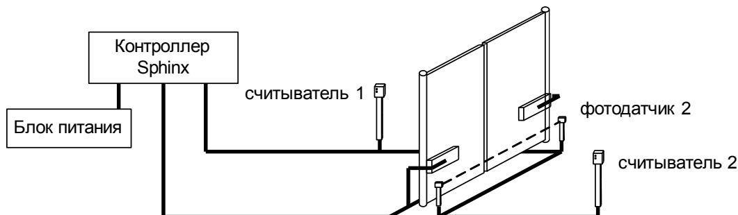
Рисунок 132. Пример автоматизации ворот с использованием карточек или меток.
