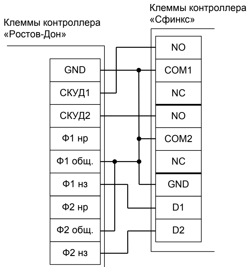
Рисунок 83. Турникеты и калитки «Ростов-Дон», новая электроника, вариант №2.
