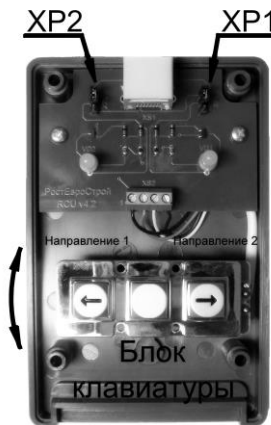
Вид пульта со снятой крышкой
