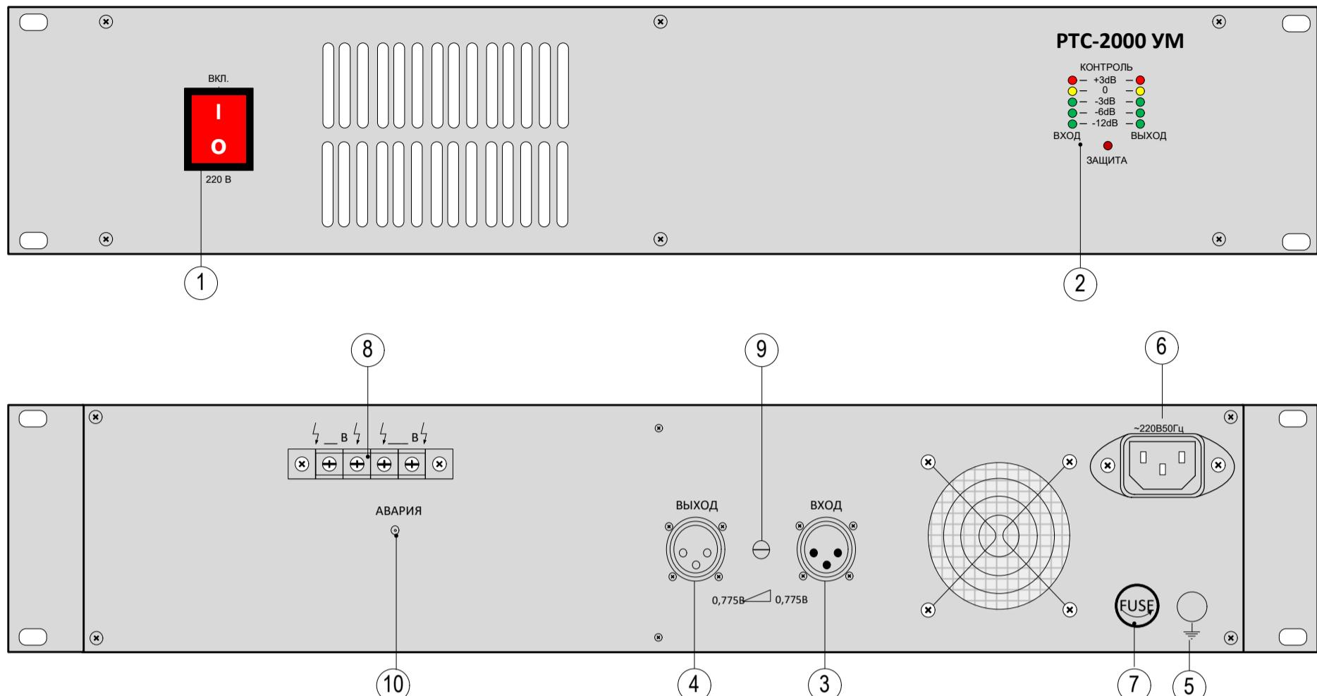
1. ВЫКЛЮЧАТЕЛЬ СЕТЕВОГО ЭЛЕКТРОПИТАНИЯ
