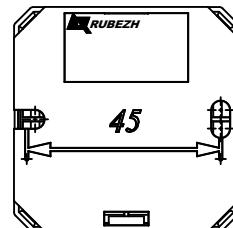
Рисунок 3 – Установочные размеры для АМ-1 прот.R3
