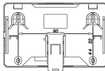
Рисунок 4 – Установочные размеры для АМ-4 прот.R3
