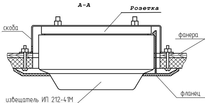
Крепление извещателя к подвесному потолку без использования комплекта монтажных частей
