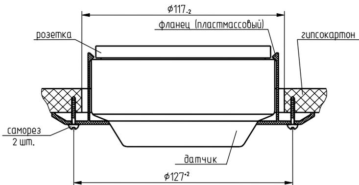
Крепление извещателя к подвесному потолку с помощью металлической скобы и пластмассового фланца (КМЧ-1)
