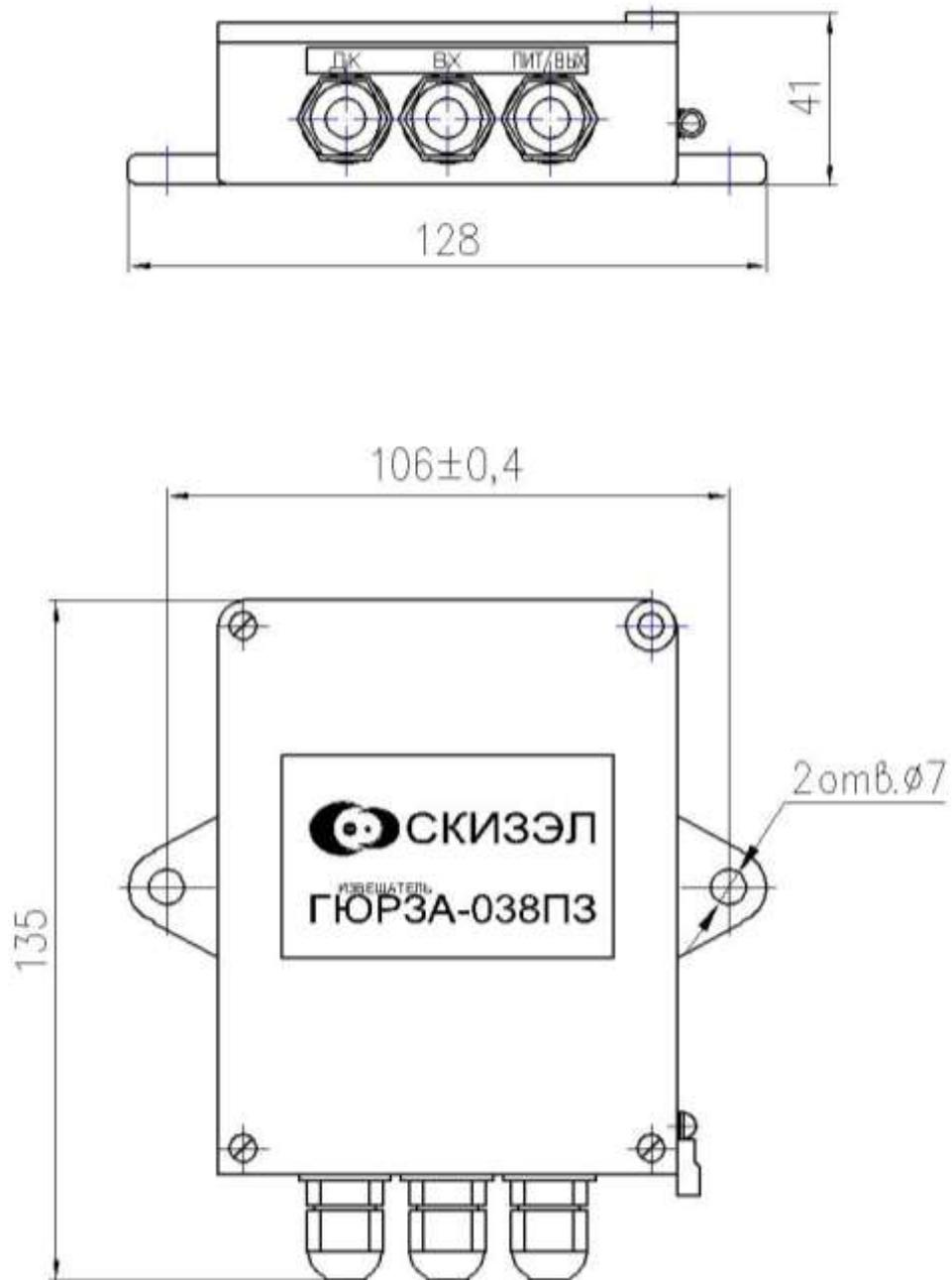
Рисунок А.1 – Блок обработки сигналов
