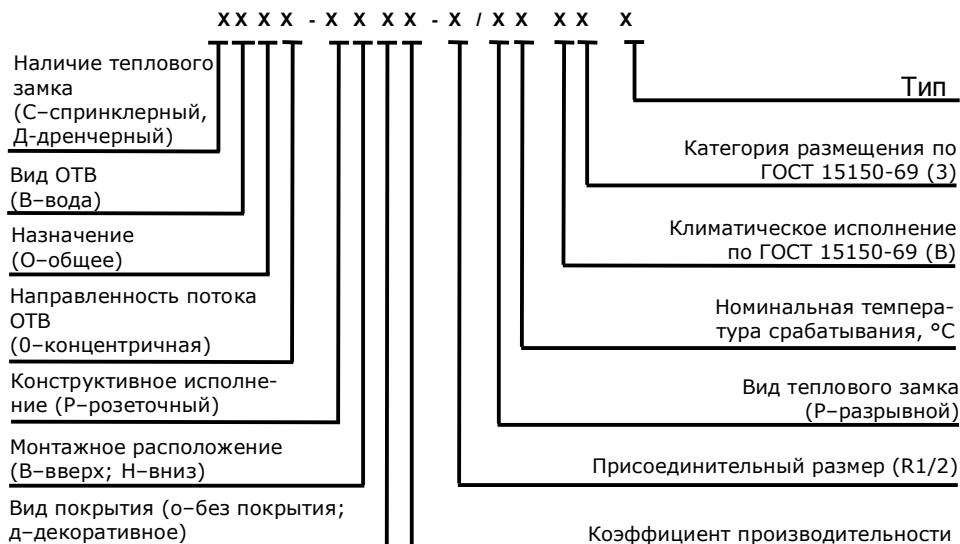
Обозначение и маркировка спринклерных оросителей по ГОСТ Р 51043-2002
