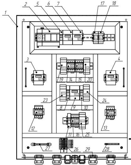
1 – корпус; 2 – программируемое реле; 3, 4 – выключатель автоматический основного и резервного ввода; 5, 6, 7, 8, 9, 10, 11 – выключатель автоматический; 12, 13 – пускатели основного и резервного насоса; 14, 15 – контактор АВР; 16 – пускатель жockey-насоса; 17, 18, – промежуточное реле; 19, 20 – реле контроля наличия фаз; 23, 24, 25 – модуль сопряжения; 26 – клеммная колодка; 27 – шина нулевая; 28 – шина заземления; 29 – кабельный ввод силовых линий.
