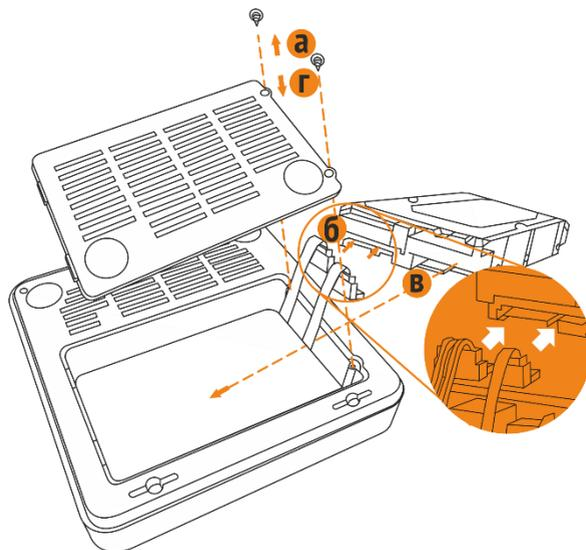
**Установка жёсткого диска в NVR300 (пластиковый корпус).**
