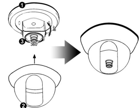
С помощью комплектного пластикового ключа отделите кожух (2), от монтажной площадки (1). Для этого установите ключ в паз между деталями и поверните его.
