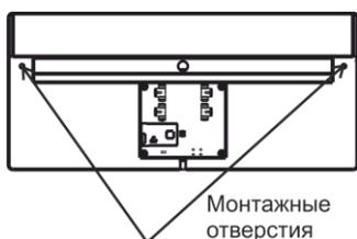
**2** Закрепить основание на стене. Установить ЭП (если были сняты) по методике п. 7.2, закрыть крышку оповещателя.
