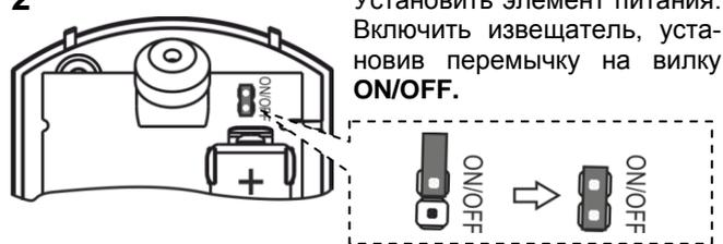
Для замены элемента питания вынуть старый элемент питания и через время не менее 20 с установить новый. При установке ЭП в извещатель автоматически производится «активация» и проверка элемента питания. При этом индикатор включен **красным** цветом (не более 20 с).
