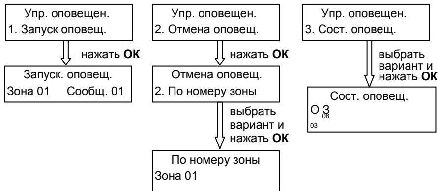
Выбор зон производится из списка, пролистывание которого обеспечивается кнопками ▼, ▲, либо цифровыми кнопками.
