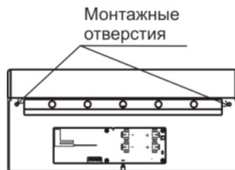
2 Закрепить основание на стене. Установить ЭП (если были сняты) по методике п. 7.2, действие 2, закрыть крышку оповещателя
