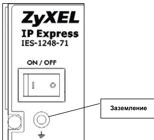
Рисунок 2-4 Заземление шасси IES-1248
