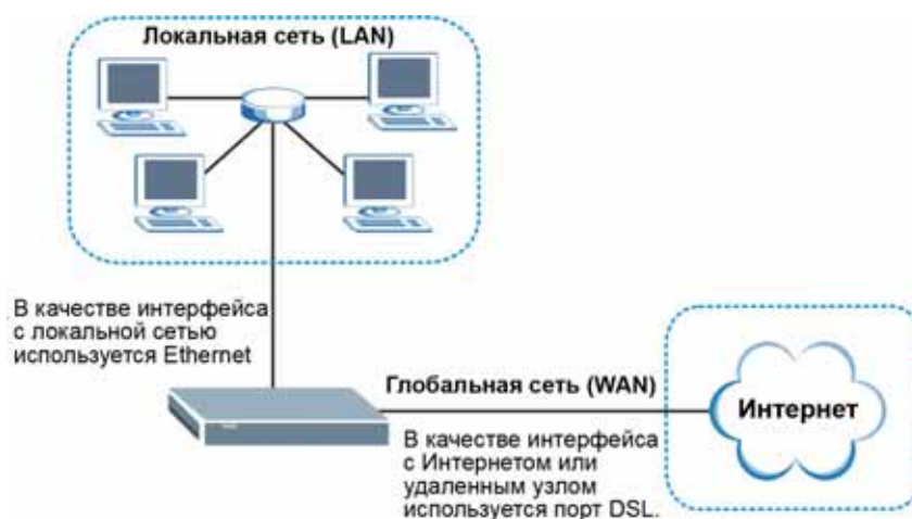
Рис. 33 IP-адреса в сетях LAN и WAN
