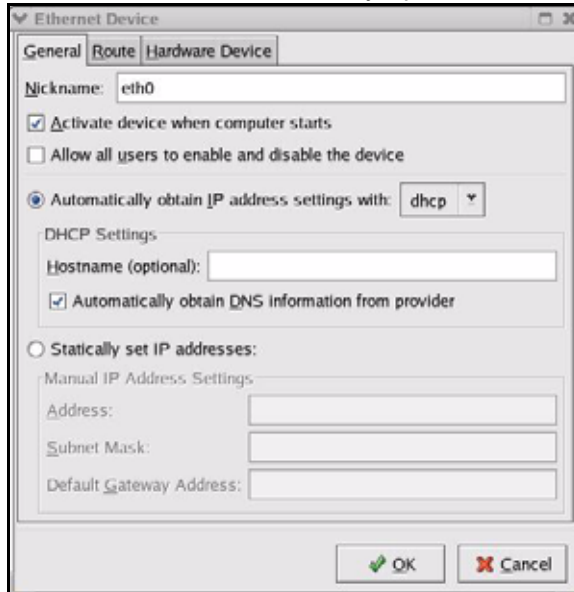
Рис. 210 Red Hat 9.0: KDE: устройство Ethernet: общие настройки
