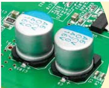
Diferentemente dos hardwares normais de switch com capacitores eletrolíticos (E-cap), os switches gerenciados em nuvem Zyxel Nebula adotam capacitores sólidos para eliminar problemas de secagem, estouro e vazamento. Os capacitores sólidos garantem switches Nebula com vida útil mais longa, alta estabilidade e operação robusta.
